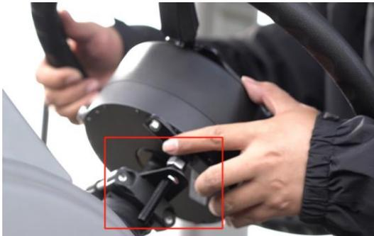
e) ステアリングホイールを保持し、ツールを使用してスプラインボルトを締めてください。
