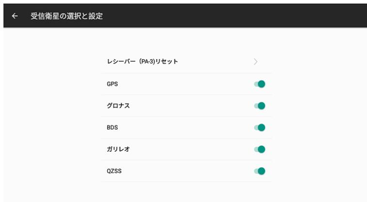
レシーバー (PA-3)リセット: 「レシーバー (PA-3)リセット」をクリックすると、受信機が再起動し、再び衛星を検索します。
