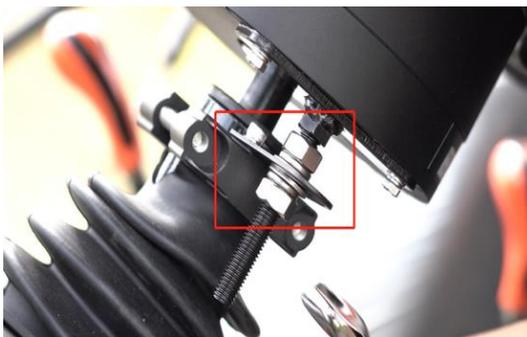
g) 最後にステアリングホイールを揺らし、締まっているかどうかを確認し、またステアリングの隙間が大きすぎないか再度確認してください。
