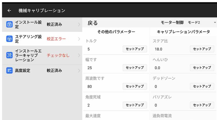
**トルク**：自動運転を停止させるためにステアリングホイールを手動で回す強度で、最小値は3、最大値は15です。
