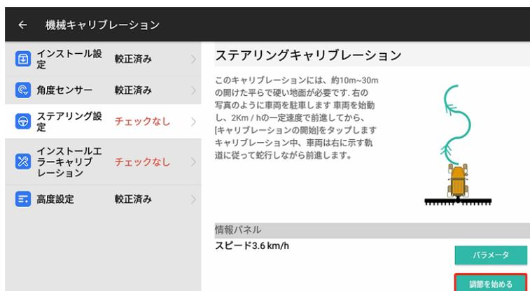
車両は自動的に “S” ラインで前進します。ステアリングコントローラのキャリブレーションが完了すると、自動的にインスト
