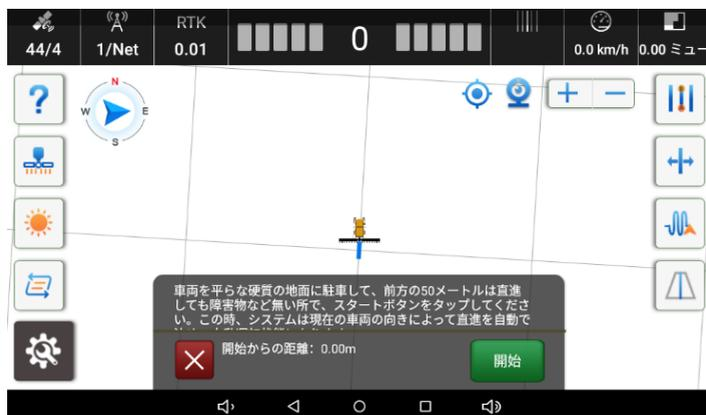
その後、[開始]をクリックし、車両は自動的にガイドラインを設定します。車両は自動モードに入ります。起点からの距離が30mを超えると、車両を停止し、[次へ]をクリックします。その後、終点を記録し、手動モードに切り替えます。
