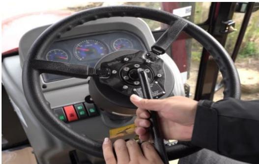
f) M10 ナット（2 個）を使用して、T ブラケットを T マウントキットにしっかりと取り付けてください。
