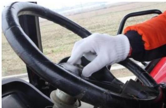
c) ステアリングホイールを引き抜いてください。取り外しが難しい場合は、ハンマーを使用してスプラインシャフトをゆっくり叩く必要がありますが、ステアリングホイールが損傷しないように注意してください。
