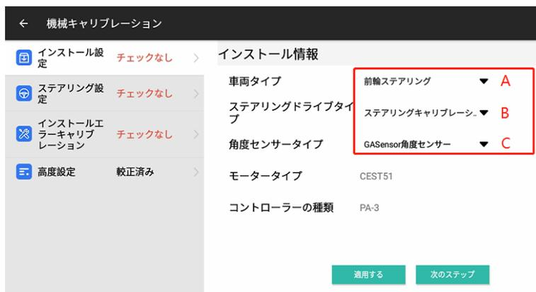
A: 車両タイプ：現在、フロントステア（前輪操舵）、リアステア（後輪操舵）、クローラー（履带式）、アーティキュレイト（中折れ式）、田植機をサポートしています。
