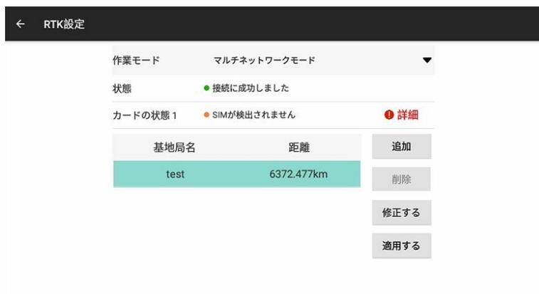
新規作成をクリックして基地局の情報を設定します。現在は CORS および APIS プロトコルがサポートされています。APIS プロトコルは CHC 独自のプロトコルであり、CHC 基地局と農業システム間でのみ動作します。
