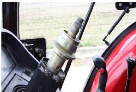
d) スリーブ（各種農機により適合するサイズが異なります）をステアリングホイールに取り付ける前に、スプラインに取り付
