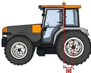
アンテナの位置：アンテナ中心（アンテナ中心の位置は受信機の青いLEDインジケータを参照してください）とリア軸との相対位置。アンテナがリア軸の前にある場合は「フロント」を選択し、アンテナがリア軸の後ろにある場合は「リア」を選択してください。
