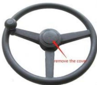
b) ステアリングホイールを固定し、スリーブツールを使用してオリジナルの車両スプラインボルトを緩め、オリジナルの車両スプラインボルトを取り外します。
