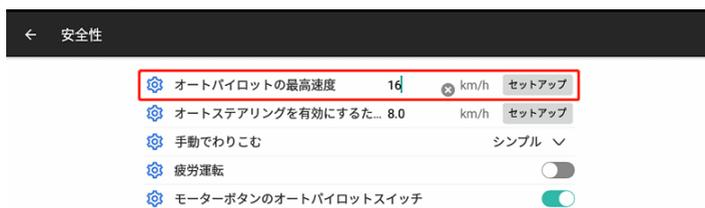
もし現在の速度がしきい値に近い場合、提示が現れ、警報が鳴ります。これにより、現在の速度が速く、オートステアリングが解除される可能性があることがユーザーに知らせます。
